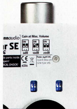
Am Mäuseklavier lässt sich der Verstärkungsfaktor um bis zu 20 dB erhöhen, z.B. für Magnetostaten
